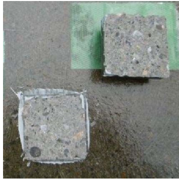
破断面にレイタンスなし
