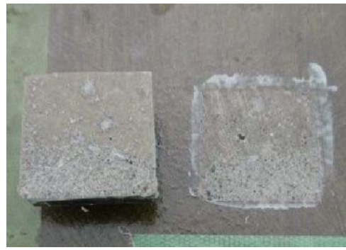
破断面にレイタンス
