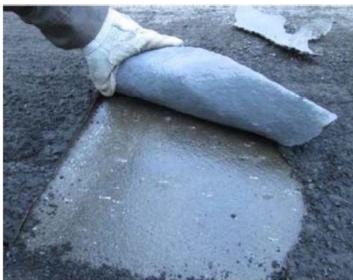
写真－2. 1 防水層の損傷事例
